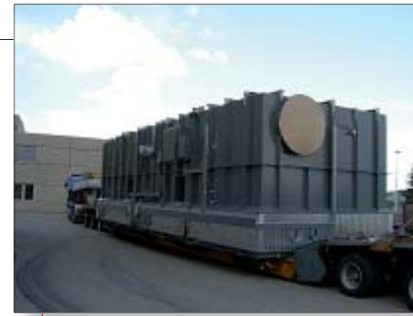
Installation einer EPSILON 3-Kammer Anlage für 60.000 Nm 3 /h in zwei Wochen von der Ankunft vor Ort bis zur Abluftübernahme
