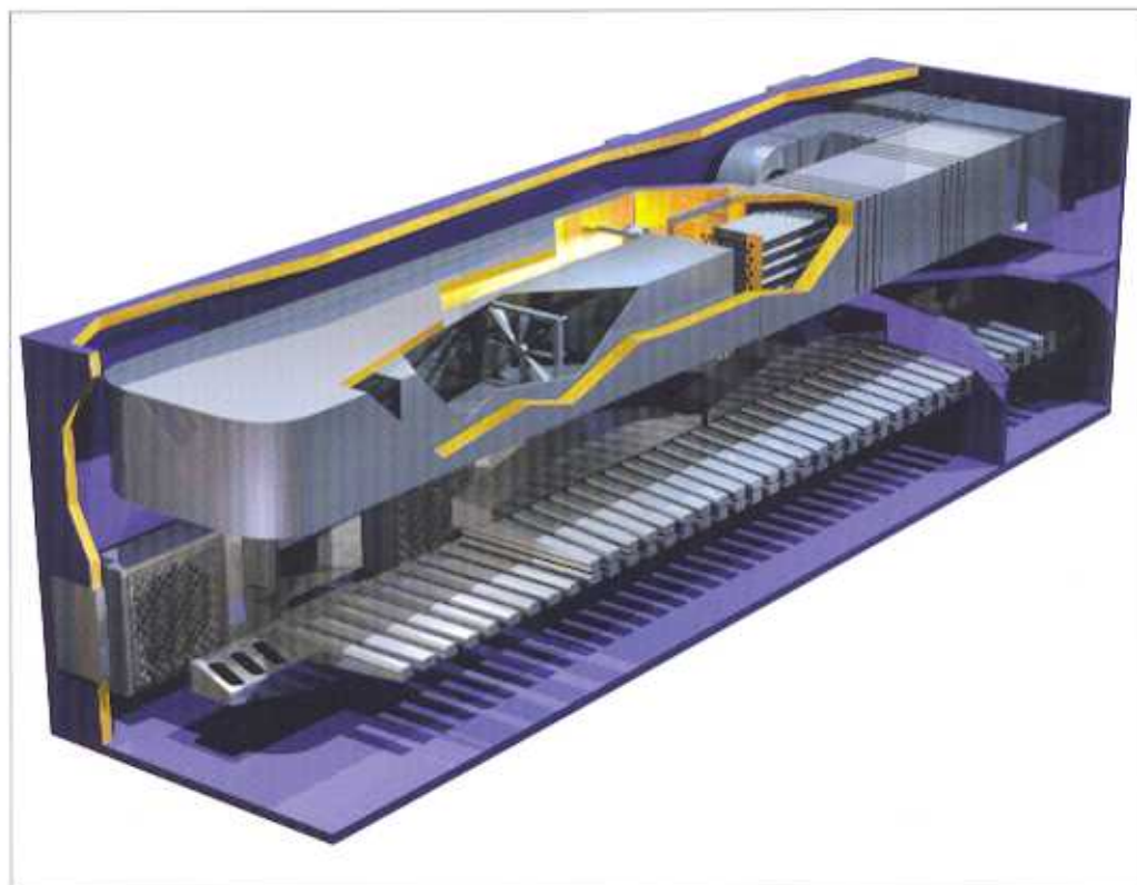
Dual-Dry TNV 的可靠技术在印刷界中创立了烘干与污气控制联成一体的功能性与经济性并成为工业标准
